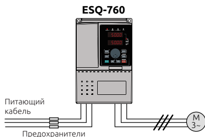
Рисунок 3-23. Схема установки предохранителей.
