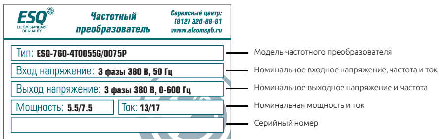
Рисунок 2-4. Изображение шильды частотного преобразователя ESQ-760
