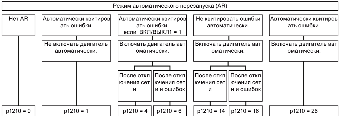
Рис. 8-25 Режимы автоматики повторного включения
