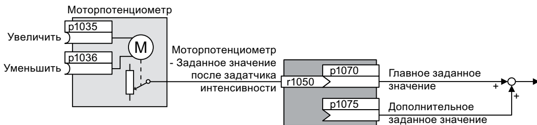
Рис. 8-14 Потенциометр двигателя как источник заданного значения
