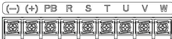
Рис 4.9 Диаграмма силовых клемм для моделей 030G/037P-037G/045P
