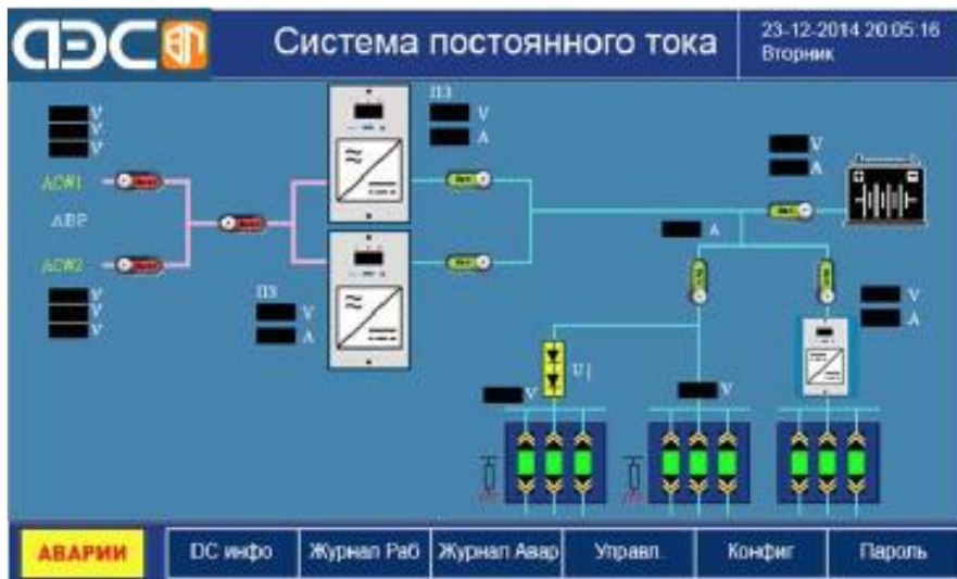
Рисунок 3. Одна группа АКБ и две группы выпрямительных модулей
