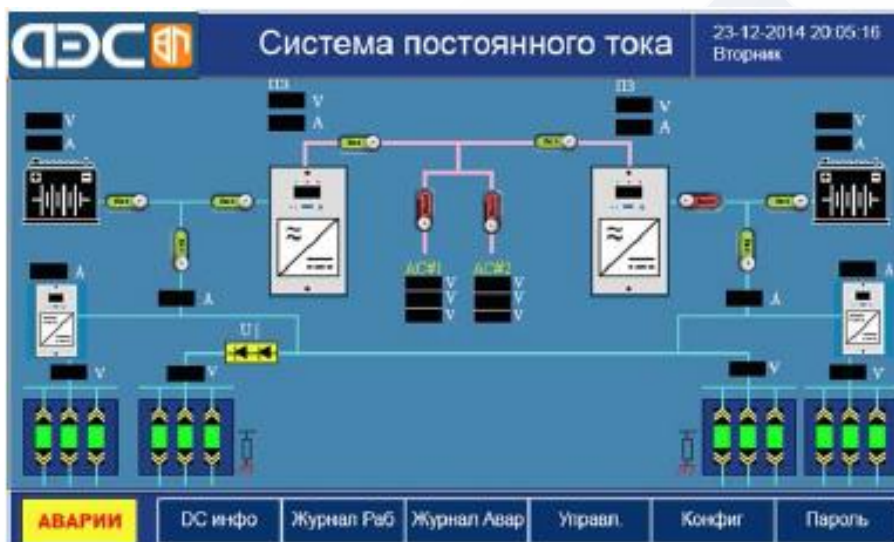
Рисунок 4. Две группы АКБ и две группы выпрямительных модулей
