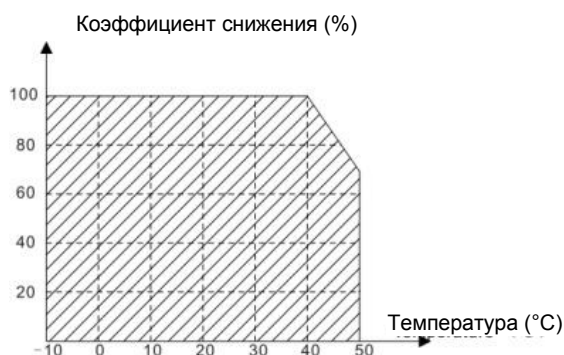
Рисунок 3-2. Снижение номинальной мощности преобразователя частоты RI20 в зависимости от температуры окружающей среды.
