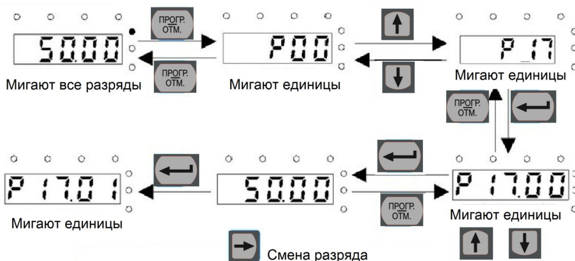
Рис. 6-5 Схема контроля состояния
