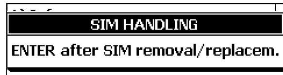
Питание модема при этом отключается, чтобы обеспечить возможность проведения операции с SIM-картой. По ее завершении нажмите клавишу **ENTER**.
