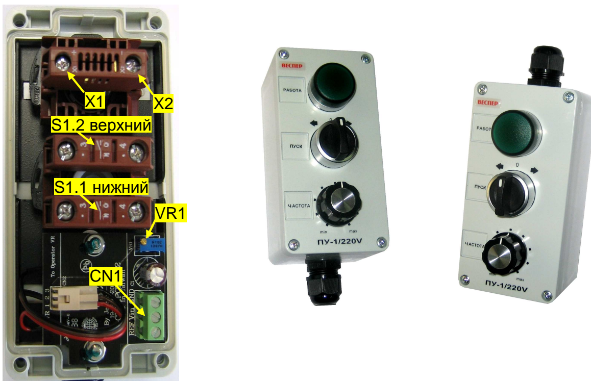
Рис. 1. Пульт управления ПУ1/220V (версия 1.1)
